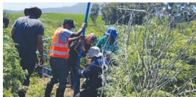
'n Drukmeter word in 'n put geïnstalleer (foto: AT Grundling)
